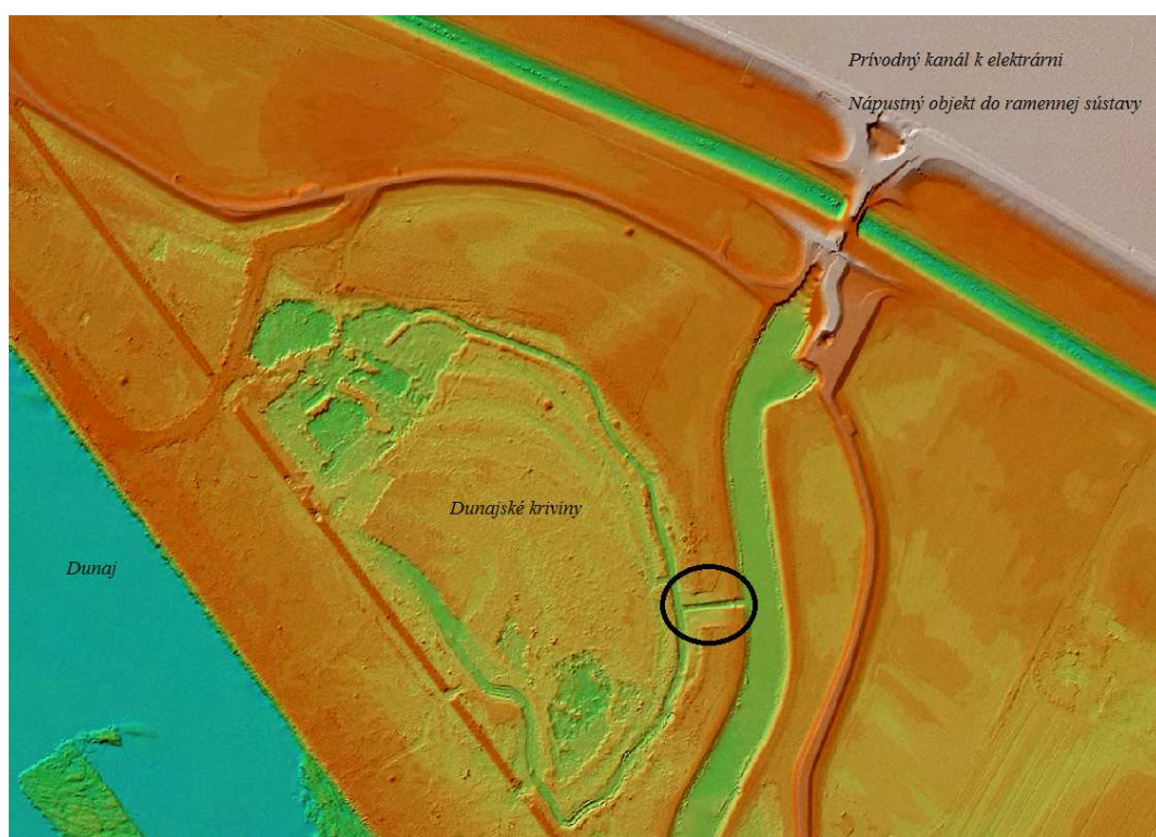
Obr. 2 Digitálny model reliéfu odvodený z lidarových dát z 9-10. decembra 2014. V čiernom ovále je dobre viditeľný vybudovaný prívod vody do ramenného systému Dunajských krivín z prírodného kanálu ramennej sústavy (MŽP SR, BROZ, 2013).
